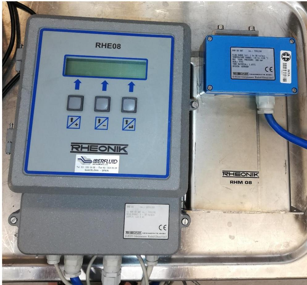
Ilustración 1. Fotografía del Indicador (izquierda) y del sensor (derecha)
