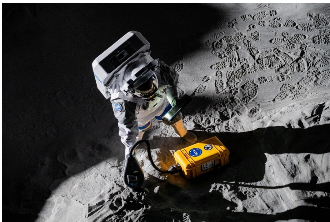
Ilustración 23. Pruebas de simulación de operación del instrumento portable Phoenix desarrollado por INTA para la misión científica PANGAEA de la ESA en la instalación LUNA del DLR.
