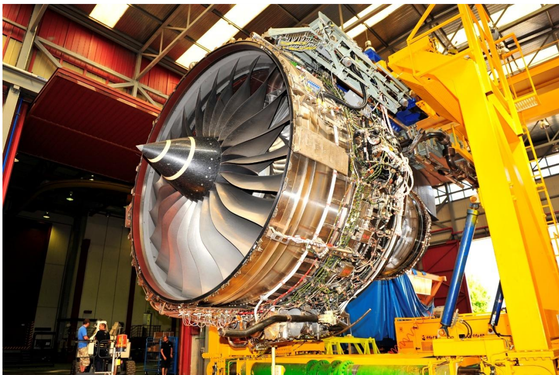
Ilustración 19. Preparación de un motor Trent XWB de Rolls-Royce para su ensayo en el banco de pruebas de Turborreactores.
