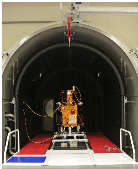
Ilustración 70. Ensayo de vacío térmico del satélite DEIMOS II en cámara climática de grandes dimensiones, en las instalaciones de INTA Torrejón.
