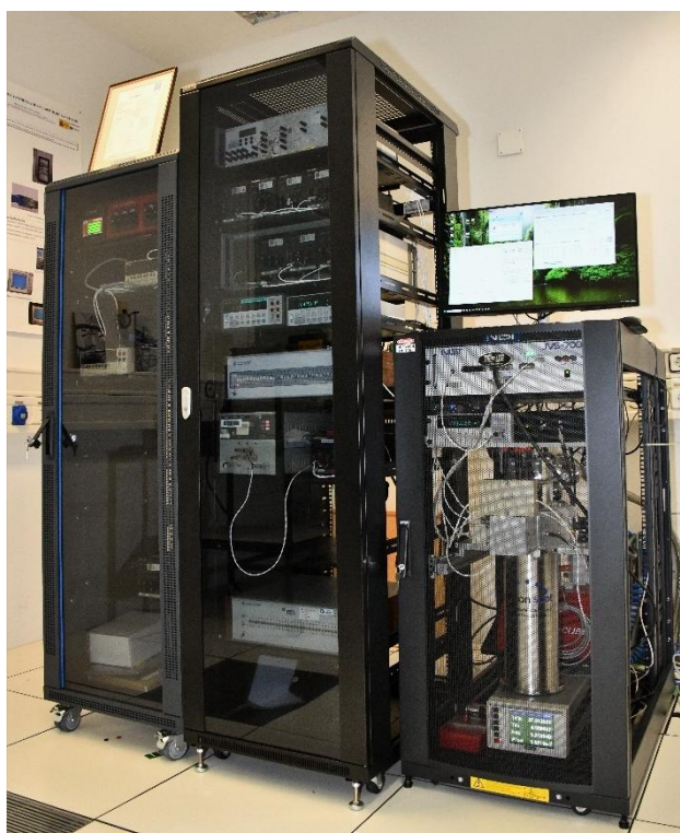
Ilustración 22. Patrón cuántico de tensión continua (Programable Josephson Voltage Standard, PJVS), empleado para la realización del voltio acorde a la nueva definición del Sistema Internacional de Unidades (SI). Este patrón garantiza la trazabilidad metrológica al SI de las medidas de tensión de los laboratorios del INTA, así como de todos los de la Red de Laboratorios del Ministerio de Defensa (RELAMDEF).
