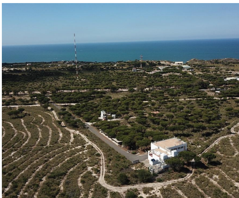
Vista aérea de la Estación de Sondeos Atmosféricos de El Arenosillo (ESAt), con su torre de 100 metros donde se miden gases de efecto invernadero en tres niveles (10, 50 y 100 m), y el océano Atlántico al fondo.
