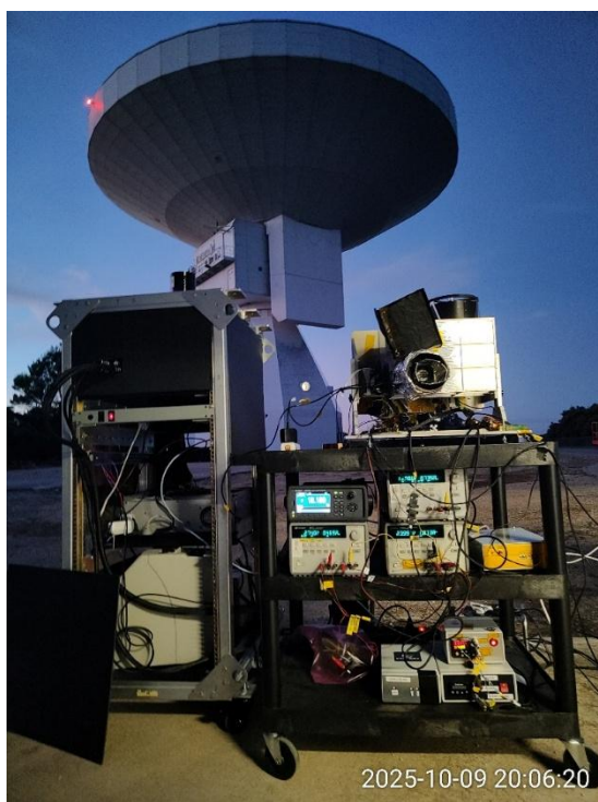
Ilustración 10: Prototipo de LIDAR marciano (MiLi) a la derecha; lidar de la Universidad de York a la izquierda. Campaña de campo en el Observatorio de Yebes. Al fondo, radiotelescopio de 40 metros (Fuente INTA)
