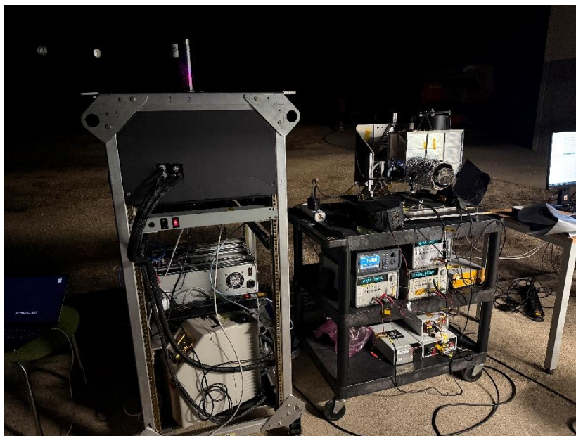
Ilustración 8: Prototipo de LIDAR marciano (MiLi) a la derecha; lidar de la Universidad de York a la izquierda. Campaña de campo en el Observatorio de Yebes (Fuente Universidad de York)
