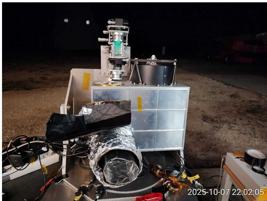
Ilustración 9: Prototipo LIDAR MiLi durante la campaña de campo en el Observatorio de Yebes (Fuente INTA)
