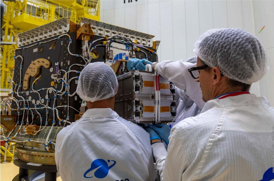
Instalación de CubeSats en el lanzador Vega
