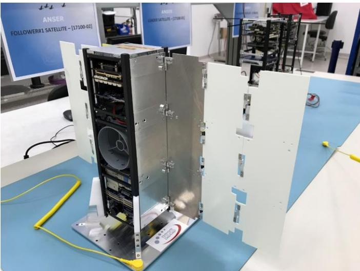
Despliegue de las solapas de CubeSat
