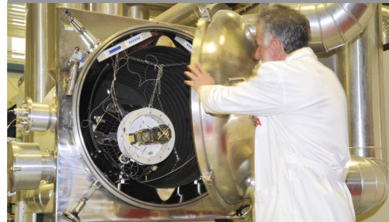
NANOSAT 1B en la cámara térmica / NANOSAT 1B in the thermal camera
